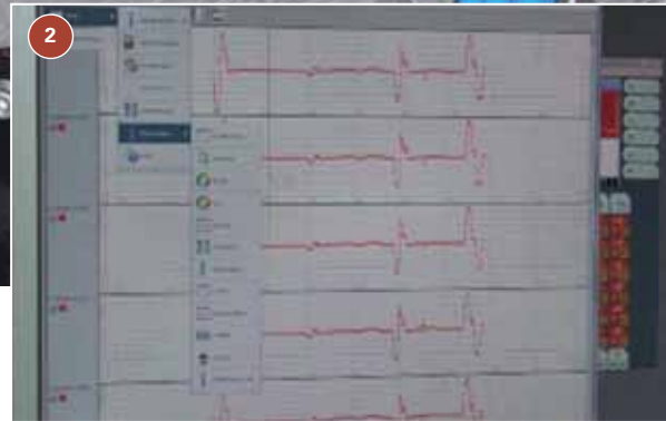
(8-1) Warnungs-Anzeige auf dem Programmierhandgerät bei Condition Monitoring Event (8-2) Sicht auf verschiedene Sensorwerte in der Robotersoftware ProVis um Schwellwerte für das Condition Monitoring zu setzen
