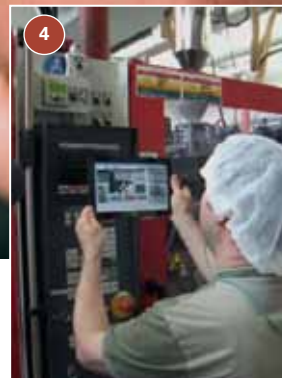
(5-1) Am Wartungspunkt Code scannen. (5-2) Anweisung lesen, Punkt überprüfen. (5-3) Anweisung quittieren. (5-4) Ggf. Foto machen.
