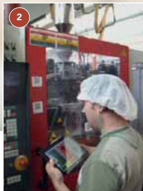
(5-1) Am Wartungspunkt Code scannen. (5-2) Anweisung lesen, Punkt überprüfen. (5-3) Anweisung quittieren. (5-4) Ggf. Foto machen.
