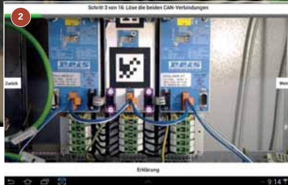
(6-1) Reparatur am Roboter-Schaltschrank mit AR-Brille (6-2) Ansicht einer AR-Anleitung auf einem Tablet-PC
