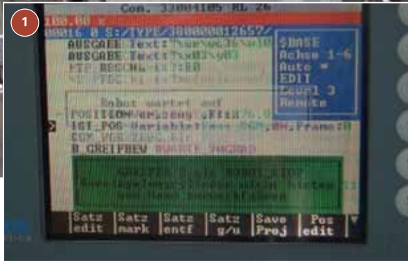
(8-1) Warnungs-Anzeige auf dem Programmierhandgerät bei Condition Monitoring Event (8-2) Sicht auf verschiedene Sensorwerte in der Robotersoftware ProVis um Schwellwerte für das Condition Monitoring zu setzen
