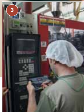
(5-1) Am Wartungspunkt Code scannen. (5-2) Anweisung lesen, Punkt überprüfen. (5-3) Anweisung quittieren. (5-4) Ggf. Foto machen.
