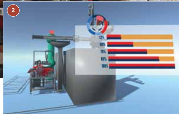
(9-1) Schema für die Integration 3D Daten mit Sensorwerten (9-2) 3D in einer begehbaren VR-Anwendung (Virtual Reality) mit Interaktionspunkten und Sensorvisualisierung
