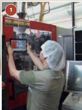
(5-1) Am Wartungspunkt Code scannen. (5-2) Anweisung lesen, Punkt überprüfen. (5-3) Anweisung quittieren. (5-4) Ggf. Foto machen.
