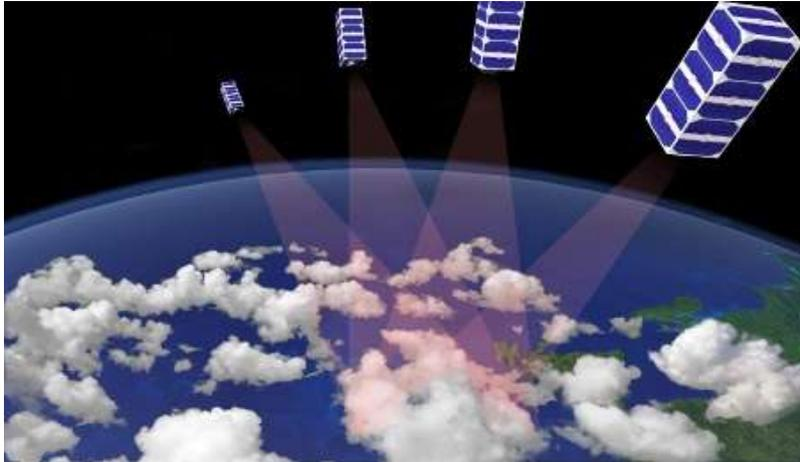
In CloudCT wird das Sonnenlicht genutzt, um einen Blick in das Innere der Wolken zu werfen. 10 Kleinst-Satelliten empfangen aus verschiedenen Blickrichtungen das Streulicht und können so das Wolkeninnere mit Hilfe ausgefeilter Software aus den Kamerabildern rekonstruieren.
